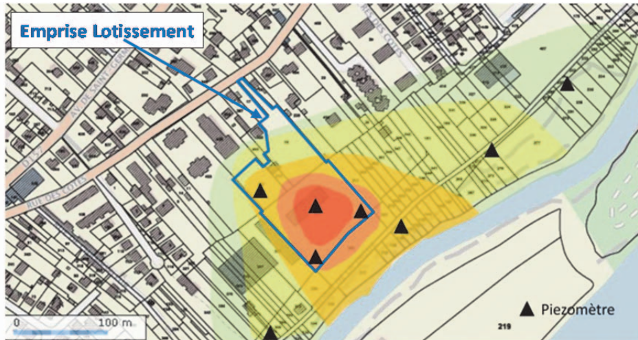
Figure 2. Extension du panache de pollution dans la nappe
