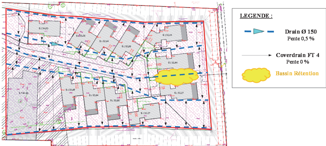
Figure 13. Plan de pose du géocomposite et des drains collecteurs
